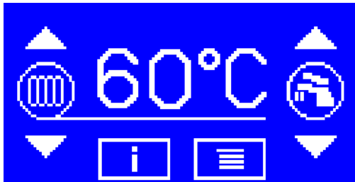
ANZEIGE DER HEIZWASSERTEMPERATUR
