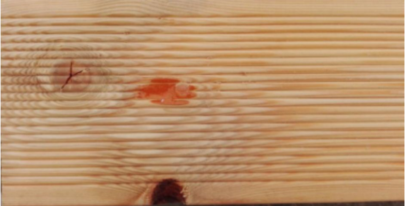
Foto 17 – ein ausgefallener Ast und Harzkammer im Querschnitt
