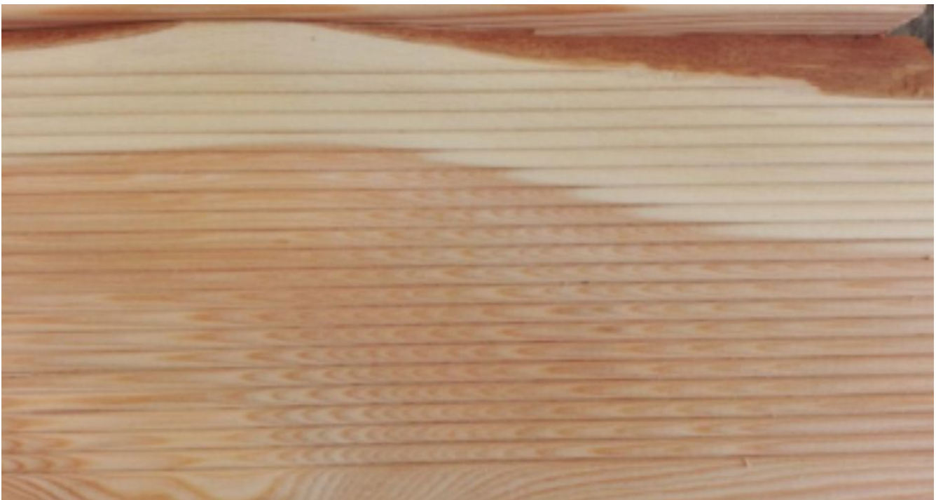
Foto 16 – Splintholz und Schwinden von Holz
