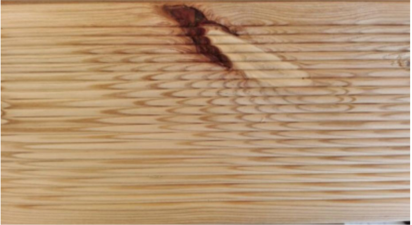
Foto 13 – Ast mit der eingewachsenen Rinde
