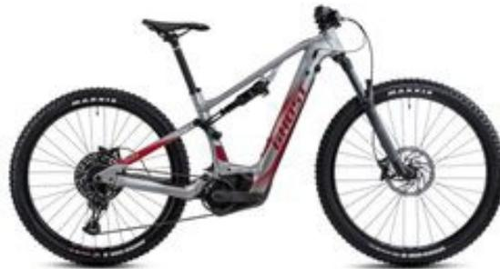
Kraftvoll bergauf. Mit voller Kontrolle bergab. Das E-ASX 130 Universal ist ein E-Mountainbike mit einem Motor der Performance Line CX von Bosch und grossem, voll integrierten 750 Wh Akku. Diese sind in das neue Bosch Smart System integriert und lassen sich über eine App exakt analysieren und vielseitig optimieren. Dank des Fahrwerks mit 130mm Federweg vorne und hinten bietet es genug Reserven auf alpinen Touren und flowigen Trails.
