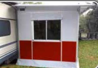
Front- und Seitenteile: hochwertige Plane 610 g/m<sup>2</sup>, werden mit angeschweißten Kedern in Aluminiumprofile eingezogen und sind jederzeit für Reparaturzwecke entfernbar. Die Plane gibt es in verschiedenen Designs.
