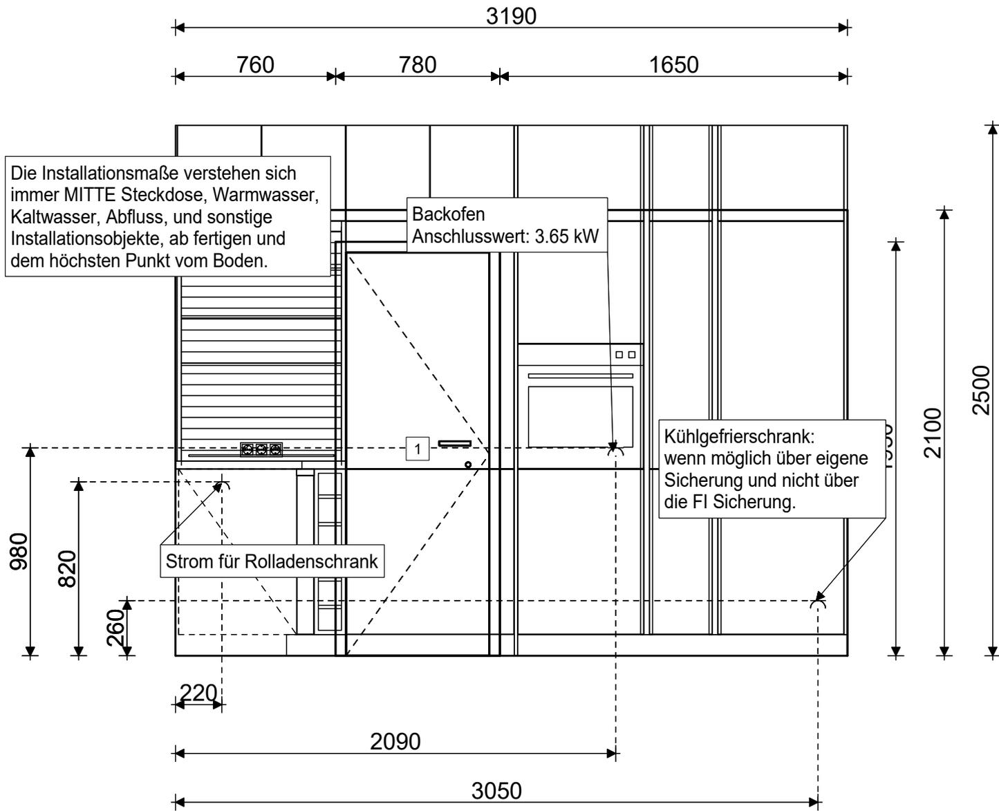
Die Installationsmaße verstehen sich immer MITTE Steckdose, Warmwasser, Kaltwasser, Abfluss, und sonstige Installationsobjekte, ab fertigen und dem höchsten Punkt vom Boden.
