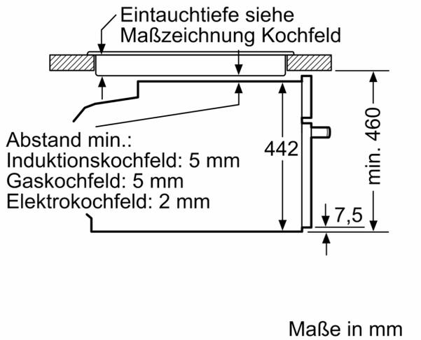
Wird das Kompaktgerät unter einem Kochfeld eingebaut, muss folgende Arbeitsplattenstärke (ggf. inkl. Unterkonstruktion) beachtet werden.
