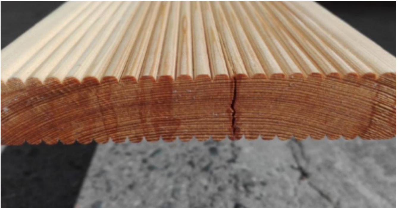
Foto 18 – ein frontal gelegener, durchlaufender Riss
